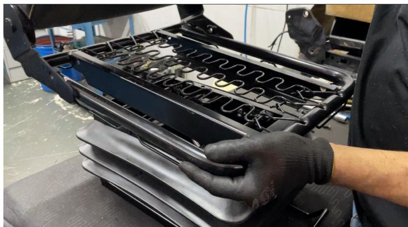
**4. Utilizando o parafuso abaulada M8 que já está incluso na suspensão, você irá parafusar fixando a estrutura na suspensão.**
