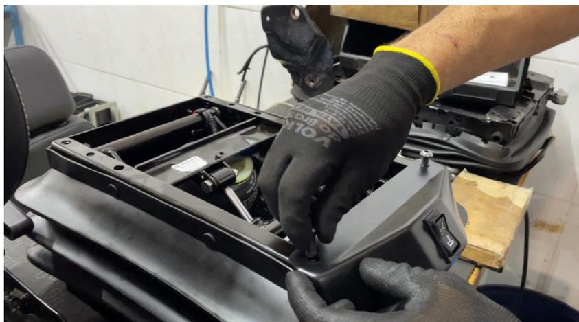
**3. Coloque a estrutura acima da suspensão com os furos alinhados.**
